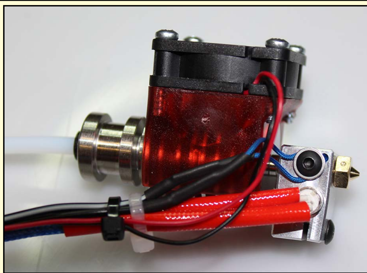
EzD-Lite6 Hot end. На первой фотографии кулер еще не присоединен, вторая — законченный вариант. Изображение: Ezd online 5
